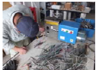
配電線の皮むき作業
